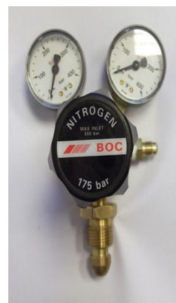
Рисунок 9. Надлежащий редуктор для опрессовки систем на R744
