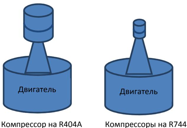
Оба компрессора обеспечивают одинаковую удельную холодопроизводительность и потребляют примерно одинаковое количество энергии.
